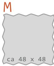
Selbstliegende Fliese mit umlaufenden Wellenschnitt zur Schachbrett- und richtungsgleichen Univerlegung (Fläche aus einem Produkt und einer Farbe) selbstliegende Fliesen für Kombinationsverlegungen im Format- und Materialmix
